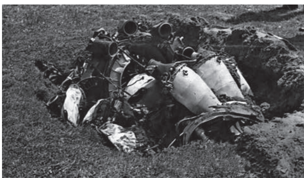
De op het voetbalveld ingeslagen rechtermotor I-230 MK8.
